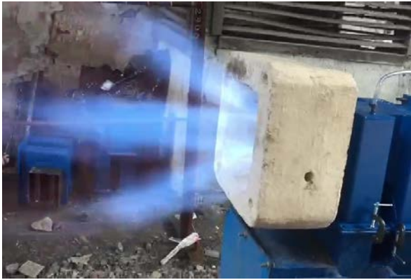
Рис. 7. Спалювання доменного газу
