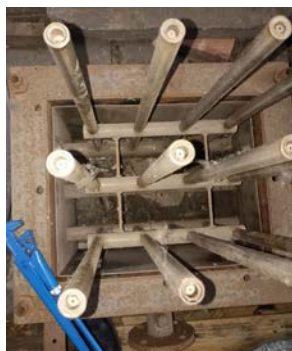
Рис. 5. Комбінований газо-мазутний струменево-нишевий паликовий прилад
