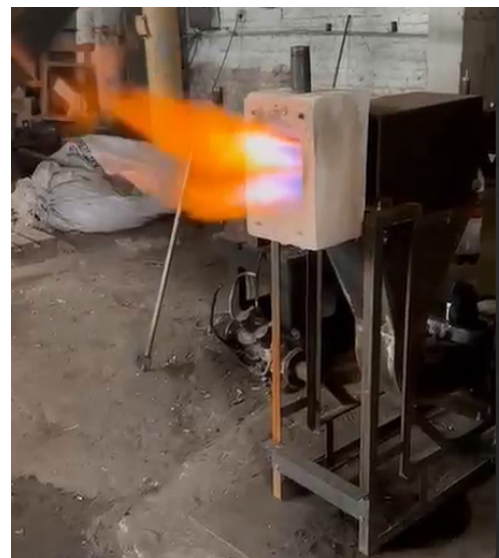
Рис. 6. Спалювання доменного газу
